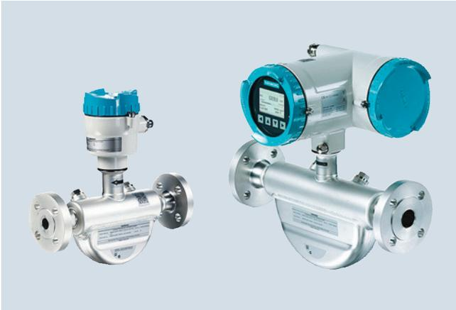
Das Prinzip der Durchflussmessung beruht auf dem Coriolis-Effekt. Die Messrohre des Messaufnehmers FCS400 werden über einen elektromechanischen Erregerkreis angeregt, der sie mit ihrer Resonanzfrequenz in Schwingungen versetzt.
